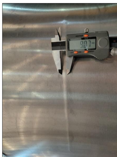
Figura 14 – Largura da marca externa do processo MIG
