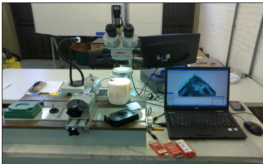
Figura 23 – Estereoscópio de captura de imagens e medição dos desgastes.
