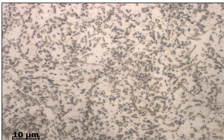
Figura 19 – Micrografia do aço SAE 5160 esferoidizado atacado com Nital a 2%.
