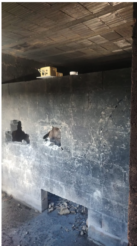
Figura 46 – Local onde foi realizado o teste de detecção de incêndio contendo o dispositivo IoT (esquerda) e o detector de fumaça utilizado como referência (direita).
