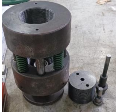
Figura 7 – Ferramental de compactação
