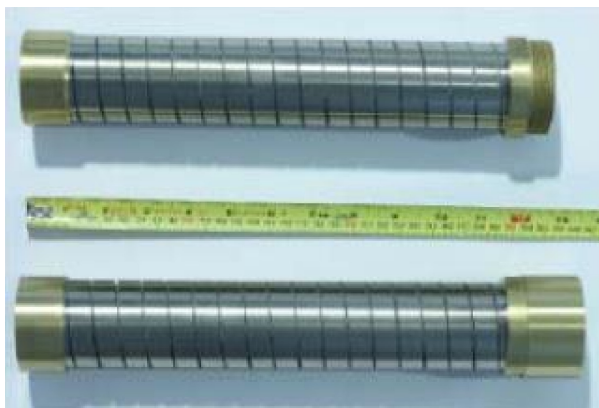
Figura 9 – Elementos supercondutores produzidos pela NEXANS.
