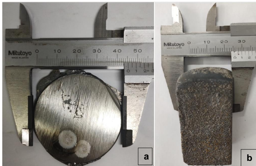
Figura 26 – (a) Amostra final destinada à análise da composição química (b) Corpo de prova para avaliação da nodularização
