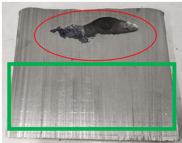
Figura 33 – Bloco Y cortado, sem a presença de defeitos visuais.
