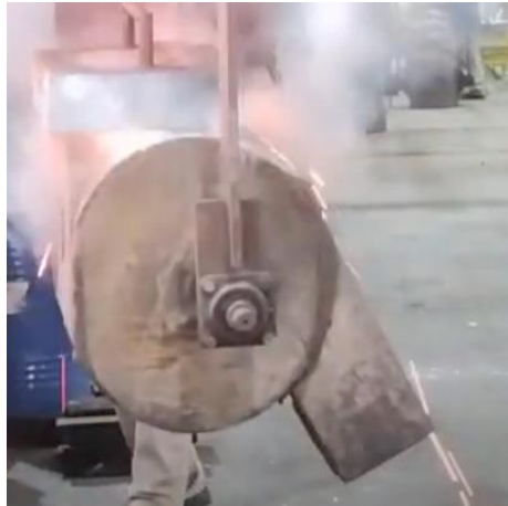
Figura 23 – Tratamento de nodularização em panela
