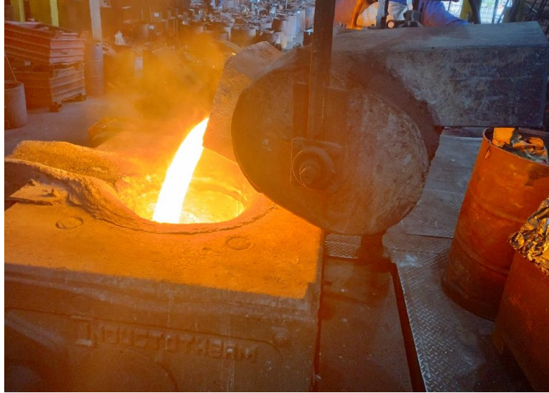
Figura 27 - Transferência do metal da panela para o forno
