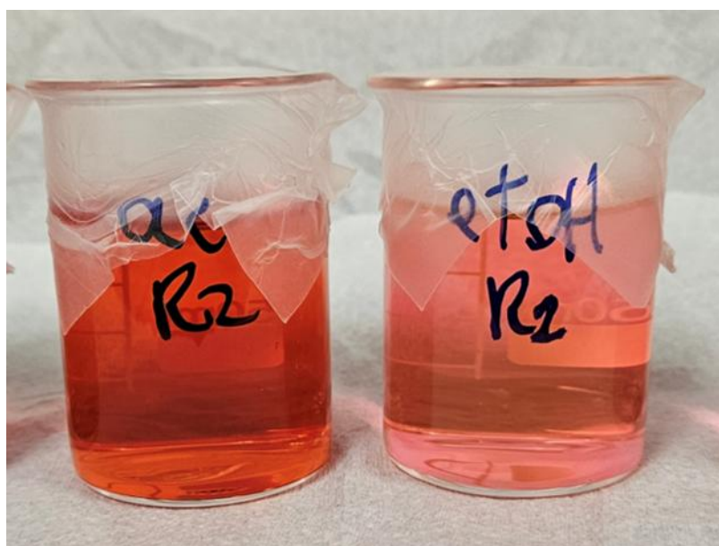
Figura 39. Solventes etanol (à direita) e ácido acético glacial (à esquerda) após etapa de dessorção de SA do adsorvente compósito
