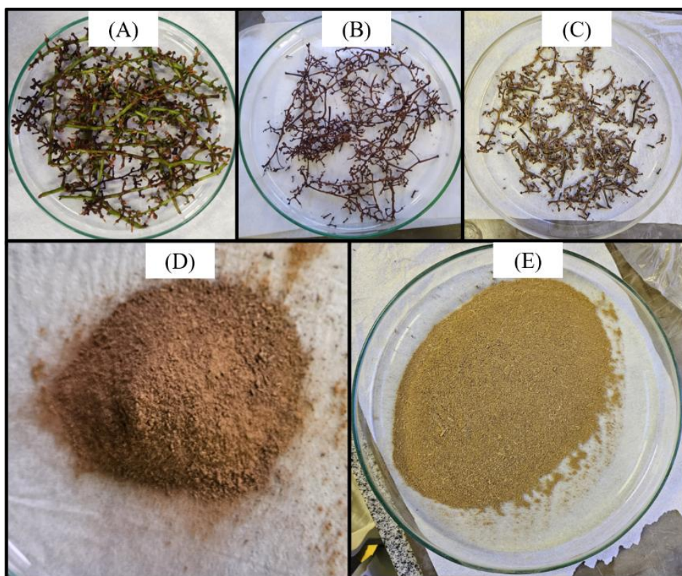
Figura 11. Engaço de uva: (A) após a lavagem em água corrente, (B) após a secagem a 110 °C, (C) após a secagem a 50 °C, (D) seco a 110 °C e moído, e (E) seco a 50 °C e moído
