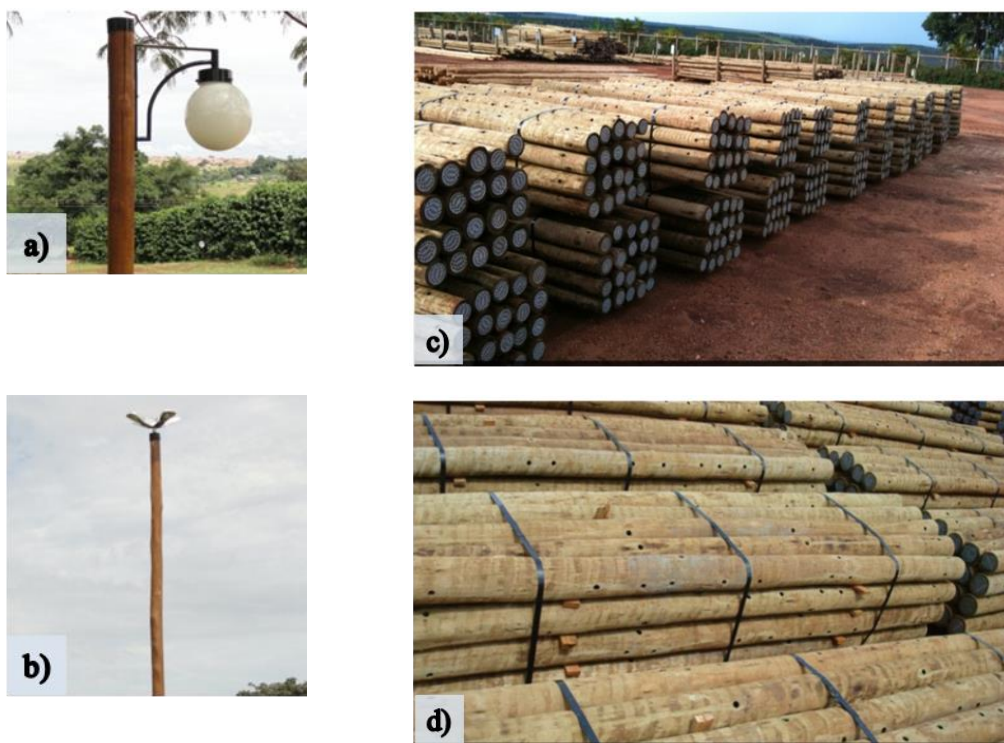
Figura 11. Exemplos de aplicações de madeiras tratadas com preservantes no segmento elétrico, onde (a) iluminação decorativa; (b) iluminação pública; e, (c) e (d) pátio de usina de preservação destinada à iluminação pública (ABPM, 2014).
