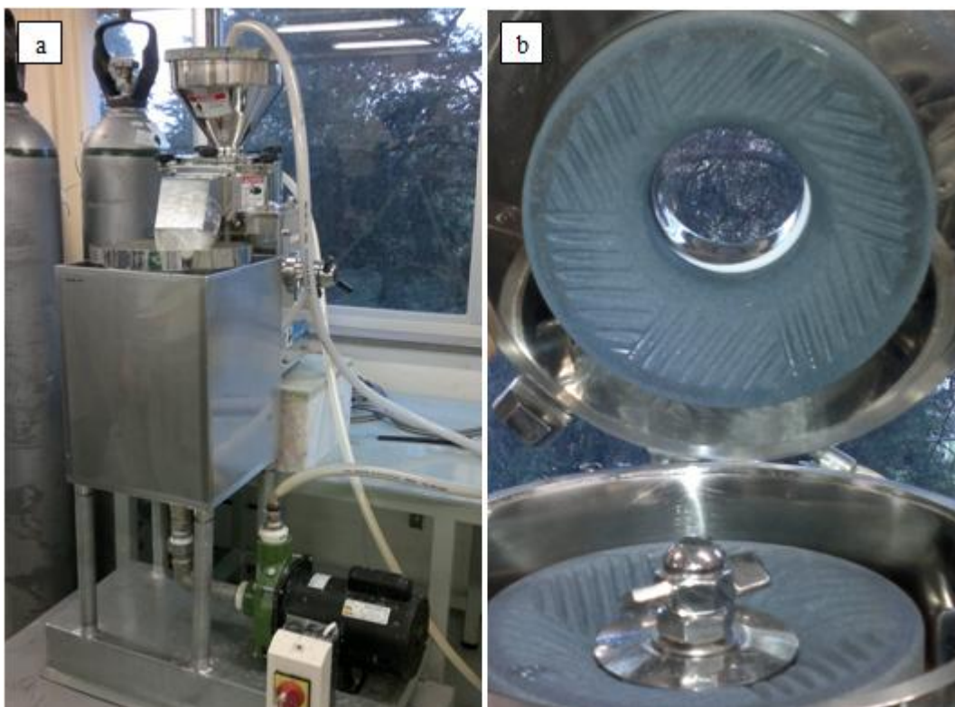
Figura 15. Sistema de refinação utilizado para obtenção de nanofibras. Nota : a) moinho e sistema de recirculação de polpa; b) aspecto dos rebolos do moinho (o autor).
