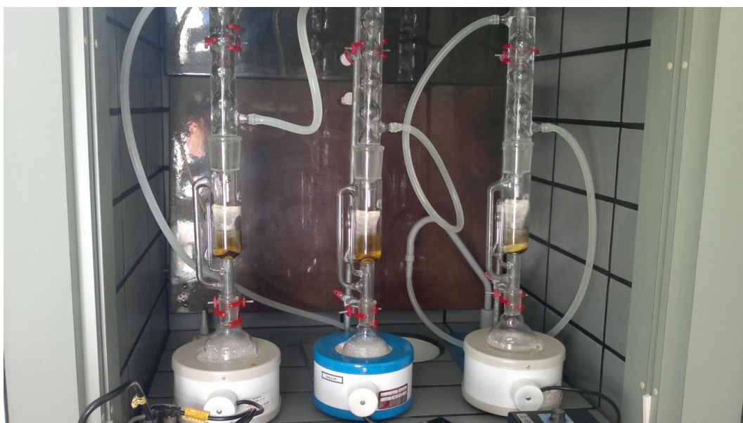
Figura B-2. Aparato utilizado para determinação do teor de extrativos (o autor)
