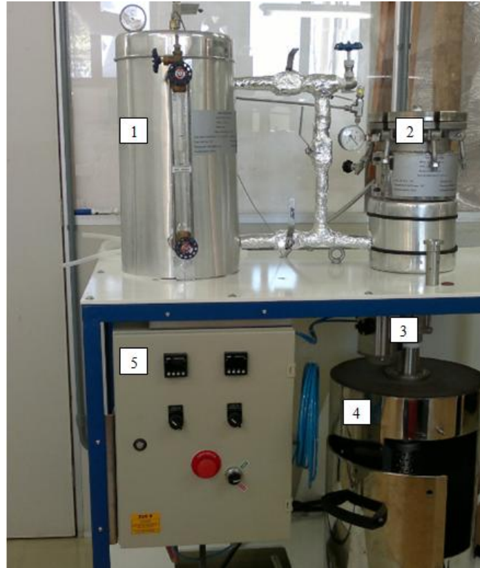
Figura 11. Fotografia do reator de explosão a vapor. (1) Boiler; (2) digestor; (3) válvula de descarga; (4) tanque de descarga; (5) painel de controle (o autor).
