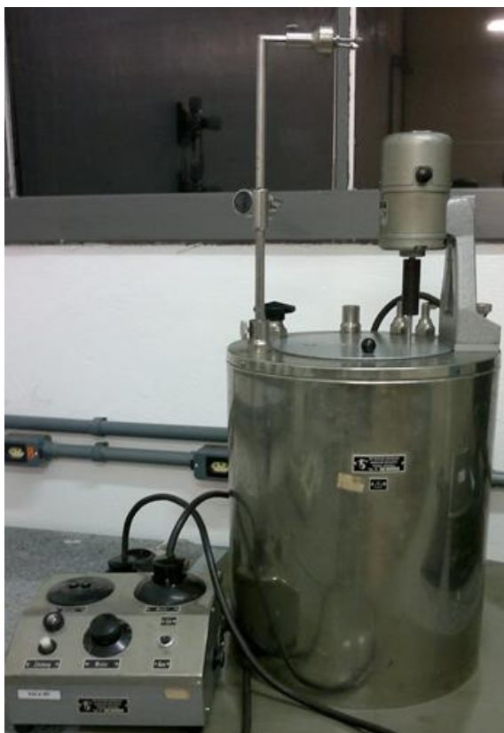
Figura 16. Bomba calorimétrica utilizada para ensaios de poder calorífico (o autor).
