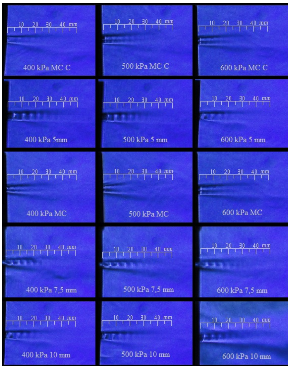
Figura 41. Imagens da técnica de Schlieren aplicada ao escoamento na descarga dos bocais ( 70\text{kg}\cdot\text{h}^{-1} )
