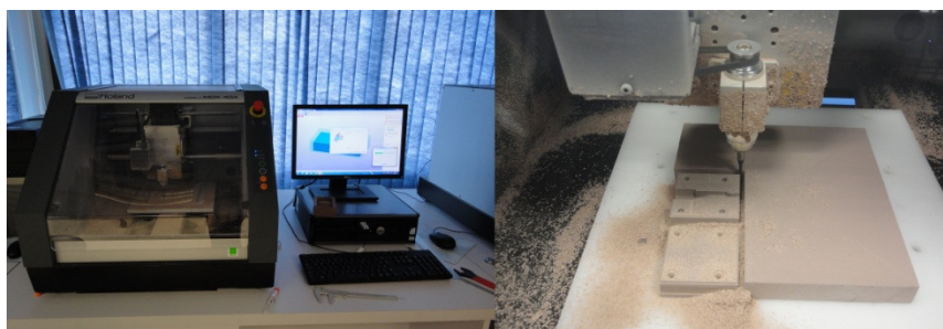
Figura 15. Usinagem dos bocais em máquina fresadora (CNC)
