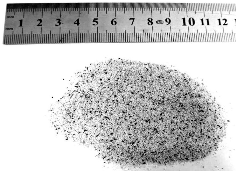
Figura 64. Fotografia do aspecto morfológico dos agregados de RIC retidos na peneira de 28 tyler mesh.
