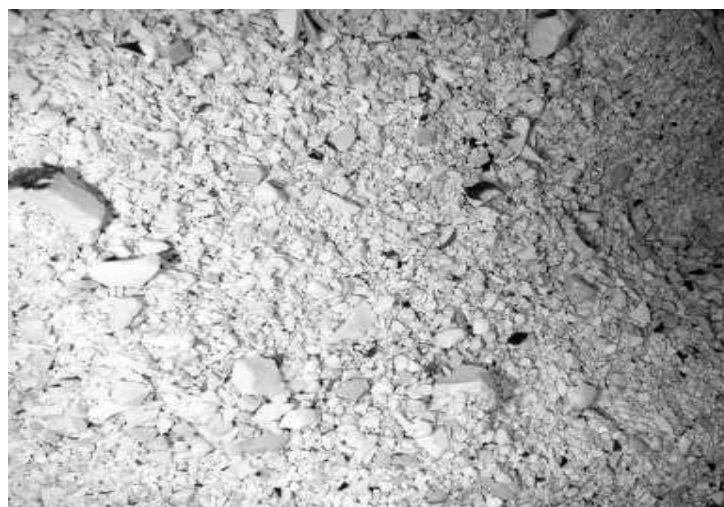
Figura 10. Resíduos dos isoladores cerâmicos após prensagem uniaxial de 40 toneladas.
