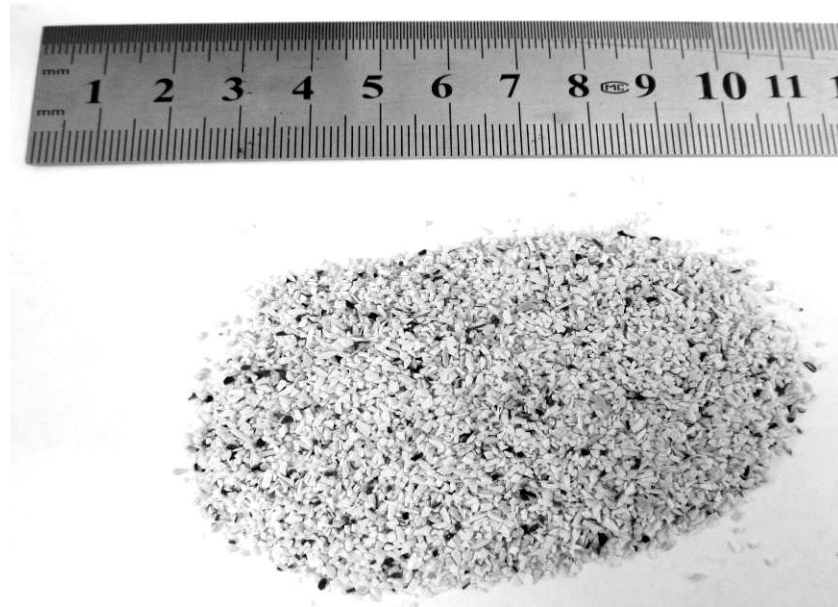
Figura 63. Fotografia do aspecto morfológico dos agregados de RIC retidos na peneira de 16 tyler mesh.
