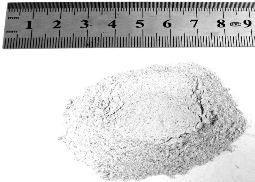
Figura 68. Fotografia do aspecto morfológico dos agregados de RIC retidos na peneira de 100 tyler mesh .
