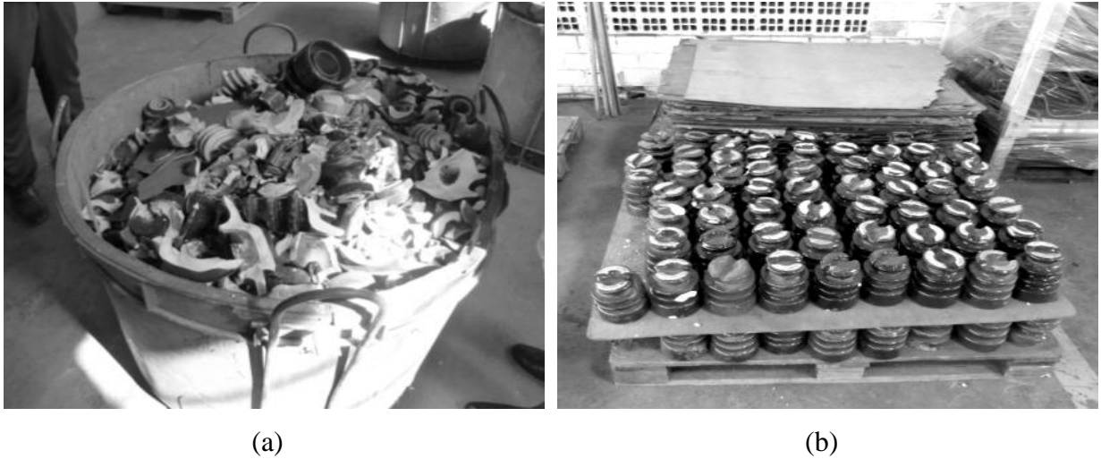
Figura 9. Resíduos de isoladores elétricos cerâmicos (a) quebrados e (b) intactos.
