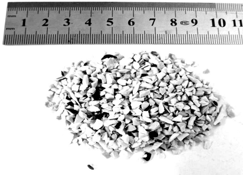
Figura 61. Fotografia do aspecto morfológico dos agregados de RIC retidos na peneira de 9 tyler mesh .
