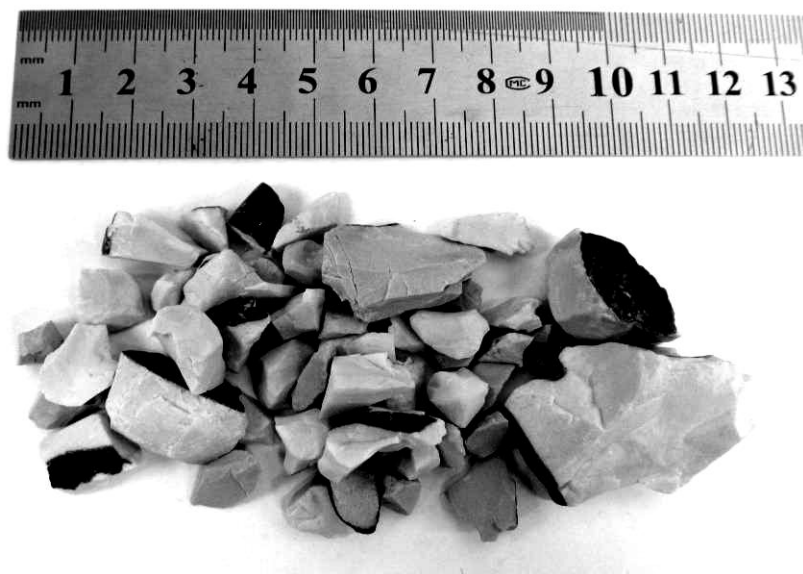
Figura 59. Fotografia do aspecto morfológico dos agregados de RIC retidos na peneira de 4 tyler mesh.
