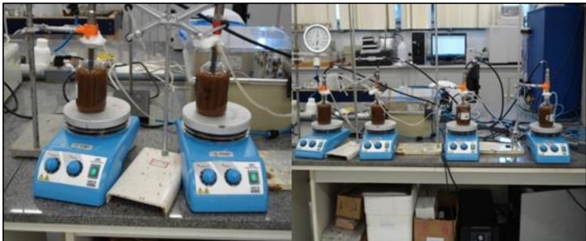
Figura 13: Respirômetro em garrafas de DBO, durante ensaio de OUR
