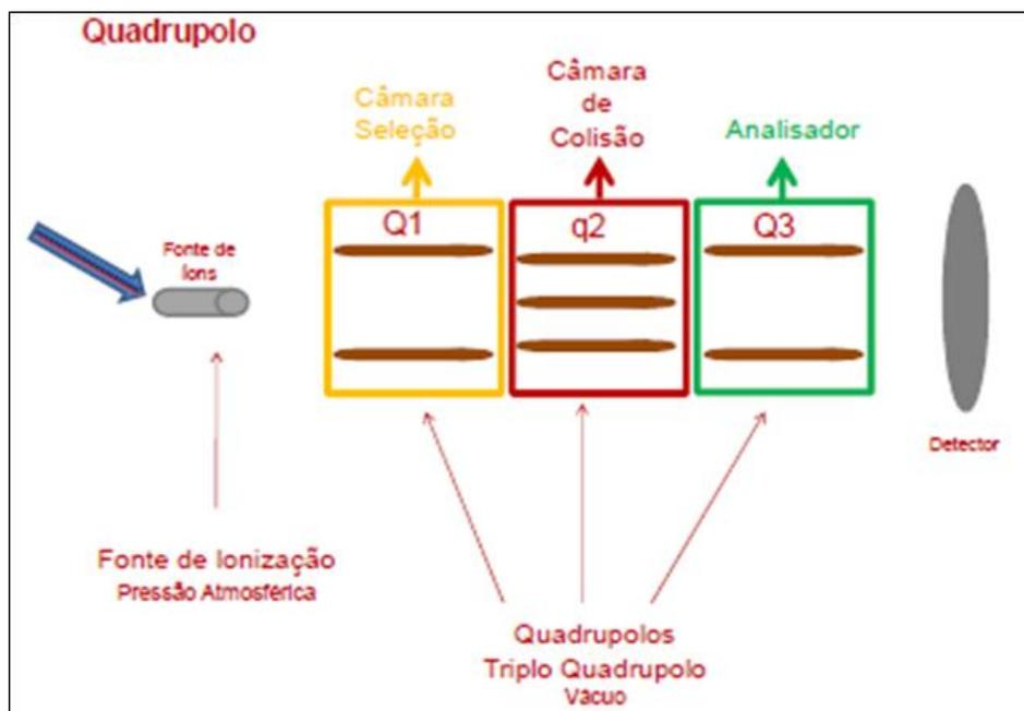
**Figura 10** – Sistema de espectrometria de massas aplicada a amostras ambientais.
