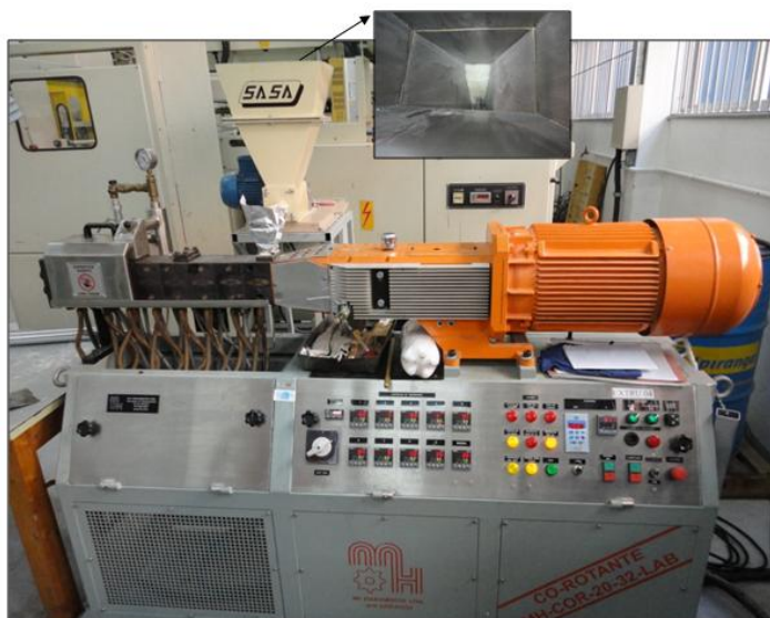
Figura 17. Extrusora duplarrosca utilizada no processamento da tinta em pó.
