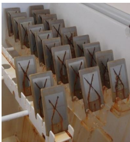
Figura 27. Sistema de fixação e posicionamento dos painéis de aço carbono revestidos com a tinta em pó durante o ensaio em câmara de névoa salina.
