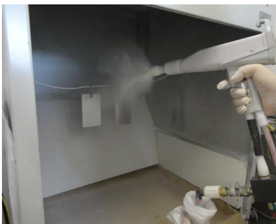
Figura 22. Aplicação por pulverização eletrostática da tinta em pó base poliéster contendo diferentes teores da argila MMT- \text{Na}^+ ou S-MMT sobre os painéis de aço carbono.
