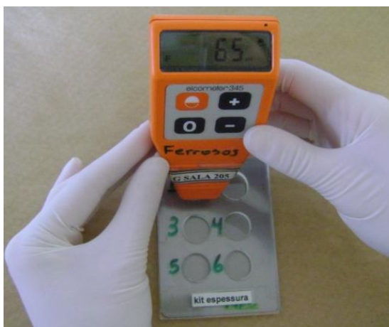
Figura 23. Medidor de espessura e gabarito utilizado nas medidas de espessura dos revestimentos.
