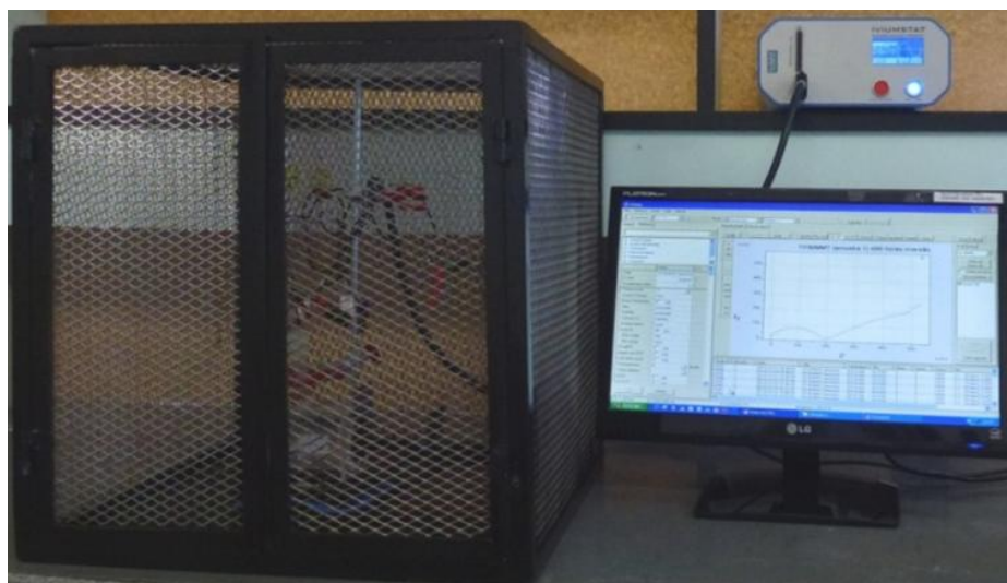
Figura 28. Sistema utilizado nas medidas de impedância eletroquímica.
