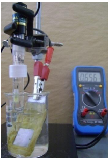
Figura 26. Sistema utilizado para determinar o potencial de circuito aberto dos revestimentos base poliéster contendo diferentes teores da argila MMT-Na + e S-MMT aplicados sobre o aço carbono.
