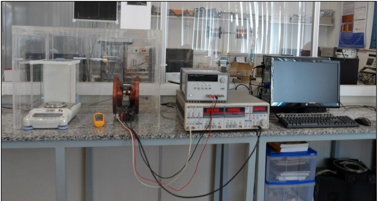
Figura 24: Configuração de monitoramento utilizando uma balança analítica, bobinas de Helmholtz, amplificador sintonizado, fonte estabilizada e computador.
