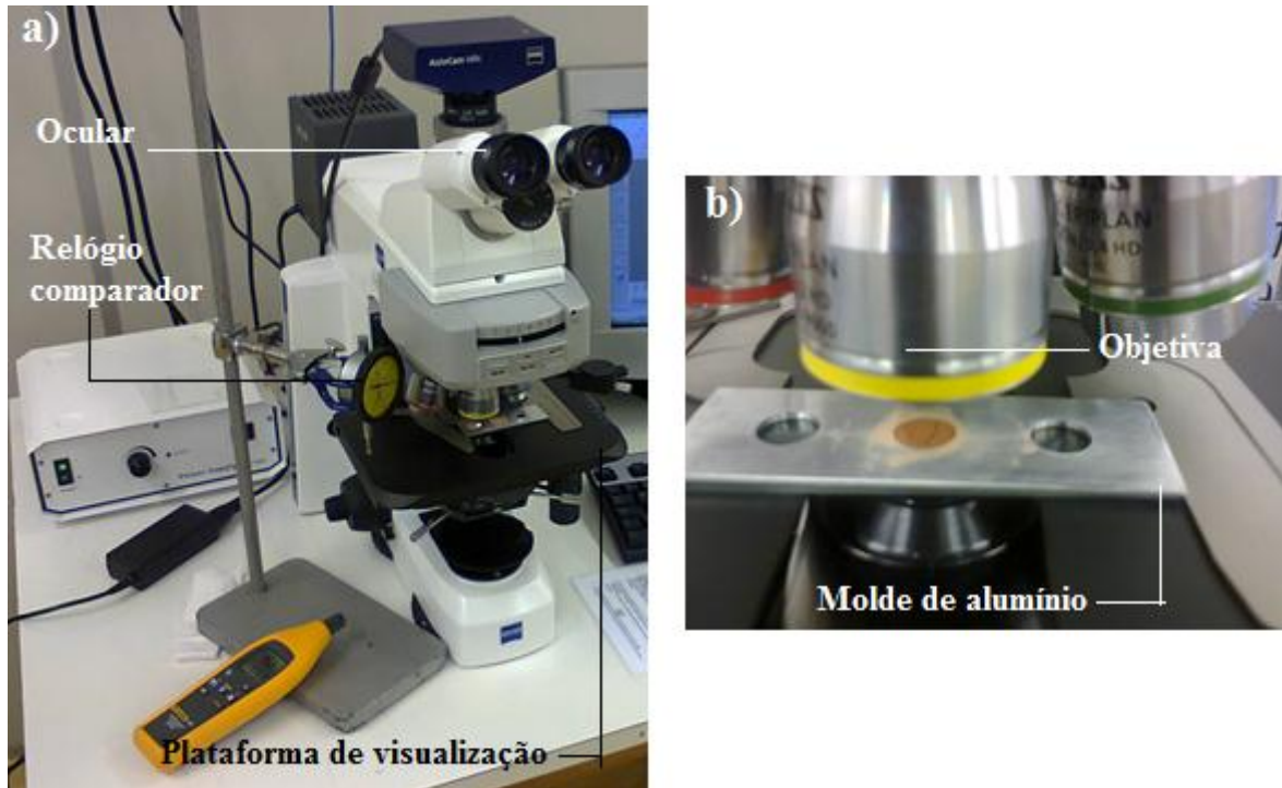
Figura 22: Sistema de medida utilizando um microscópio ótico e um relógio comparador para medir a retração da argila disposta no molde de alumínio.
