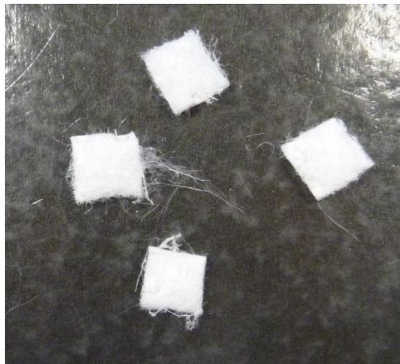
Figura 12: Corpos de prova utilizados nos ensaios cinéticos de sorção de óleos nas dimensões de 1,5 x 1,5 cm.
