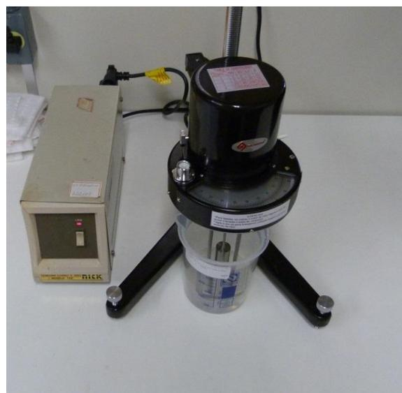
Figura 7: Viscosímetro Quimis Q860A utilizado na análise da viscosidade do diesel.
