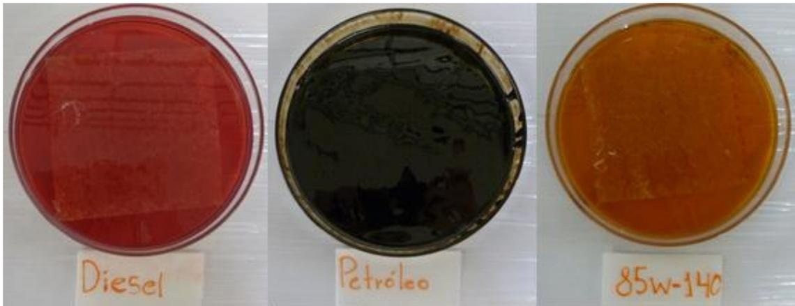
Figura 9: Ensaio de sorção de diesel, petróleo e óleo lubrificante segundo método ASTM 726-12.
