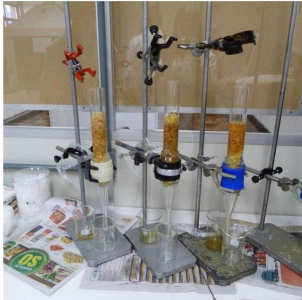
Figura 10: Câmaras de contato construídas para os ensaios conforme especificações da norma CT BIO n.º 95.
