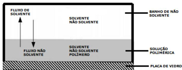
**Figura 5.** Representação esquemática da interface solvente/não solvente/polímero (Adaptado de Poole *et al.*, 2000).
