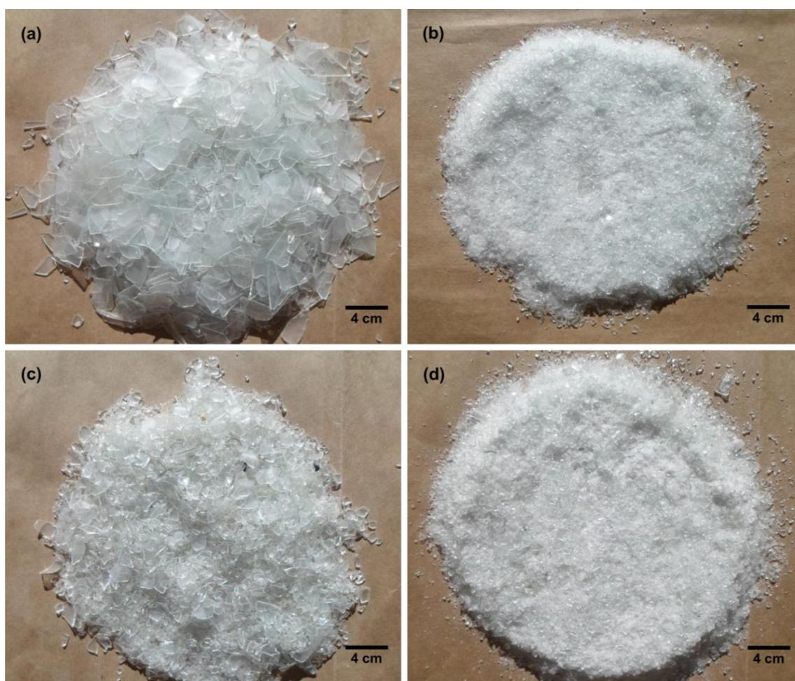
**Figura 11.** Vidro de lâmpadas (a) tubulares antes e (b) após compressão e vidro de lâmpadas (c) compactas antes e (d) após compressão.
