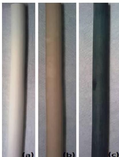
**Figura 30.** Suporte cerâmico (a), após imersão em solução de sensibilização e ativação (b) e com camada de Pd depositada (c).
