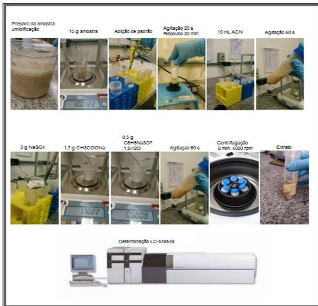
Figura 2. Esquema do procedimento realizado para o método QuEChERS modificado
