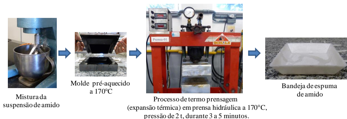
Figura 12. Processo de expansão térmica utilizado para obtenção das espumas de amido de mandioca
