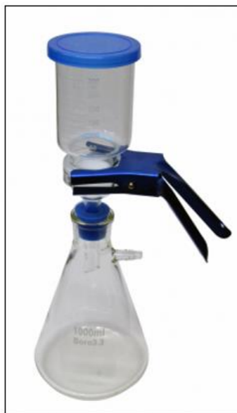
Figura 11. Sistema de filtração a vácuo (QUIMIS, 2021).
