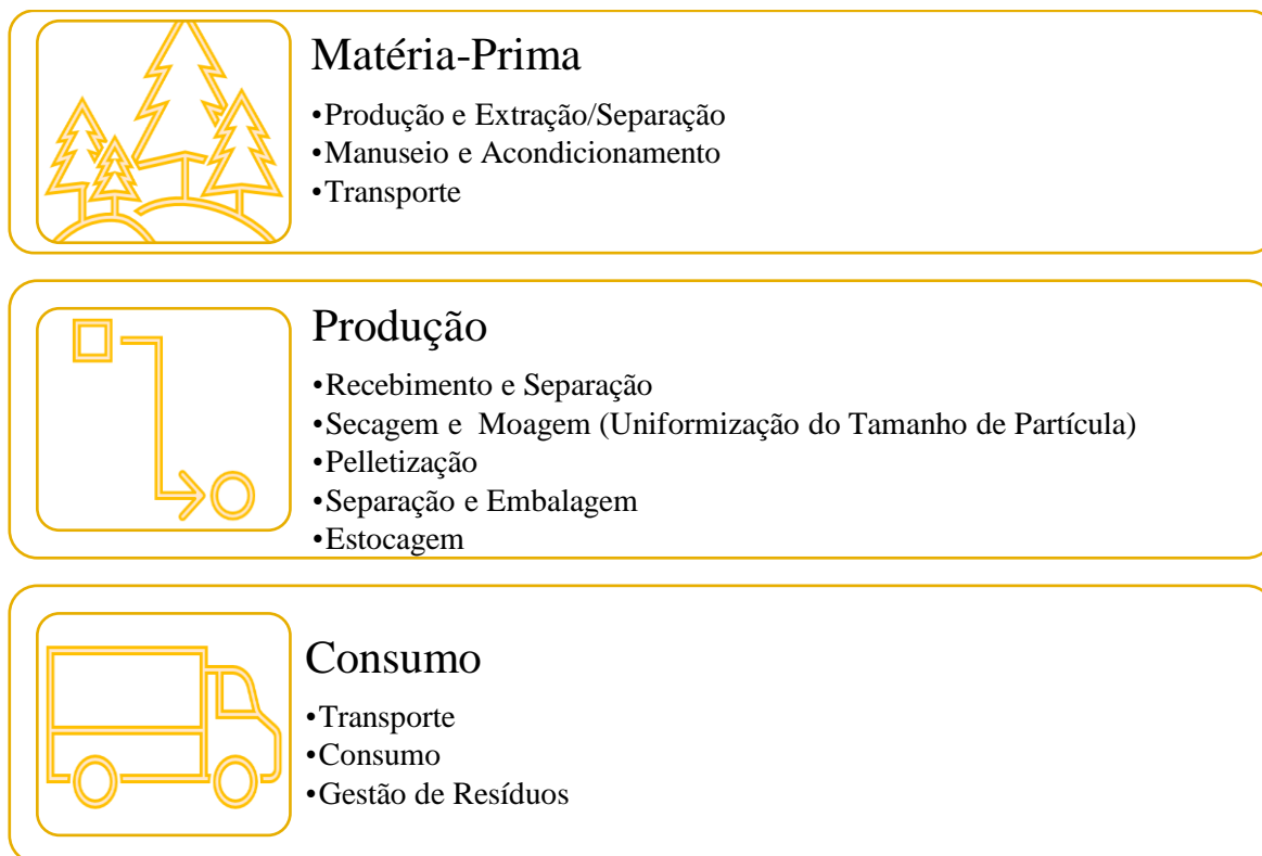
Figura 4. Ciclo de produção do pellet (adaptado de KONRÁD et al. , 2018).
