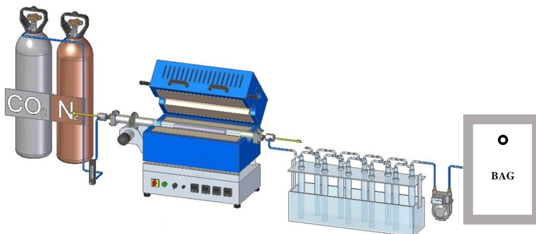
Figura 9. Esquema do reator utilizado para os ensaios de gaseificação. (Adaptado de MANERA et al. (2020)).
