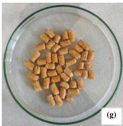
Figura 8. Etapas do processamento de madeira até a obtenção do pellet: (a) toras de Pinus elliottii , (b) desdobramento da madeira, (c) serragem, (d) recebimento de serragem para pelletização, (e) extrusora para produção de pellet, (f) matriz da extrusora e (g) pellet (elaboração da Autora).
