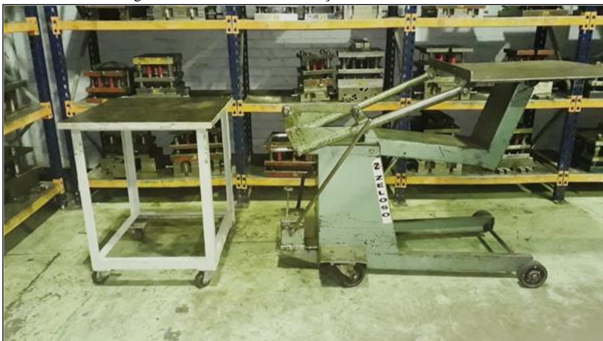
Figura 19 - Carrinhos de colocação e retirada de matrizes
