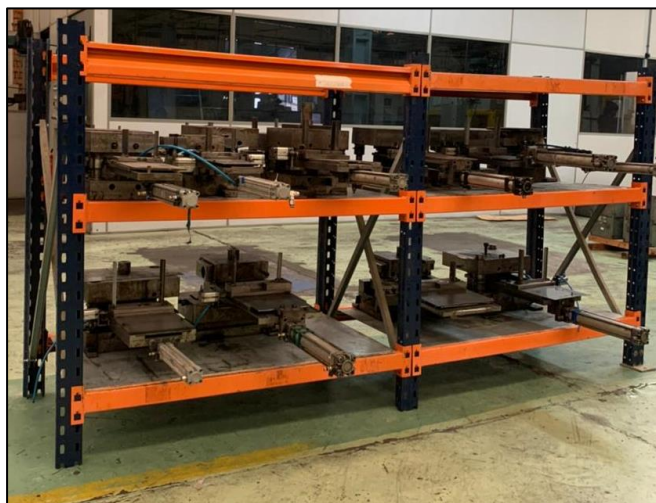
Figura 22 - Estante de armazenamento de matrizes de conformação
