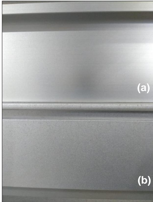
Nota: (a) Corpo de prova jateado e anodizado; (b) Corpo de prova jateado.
