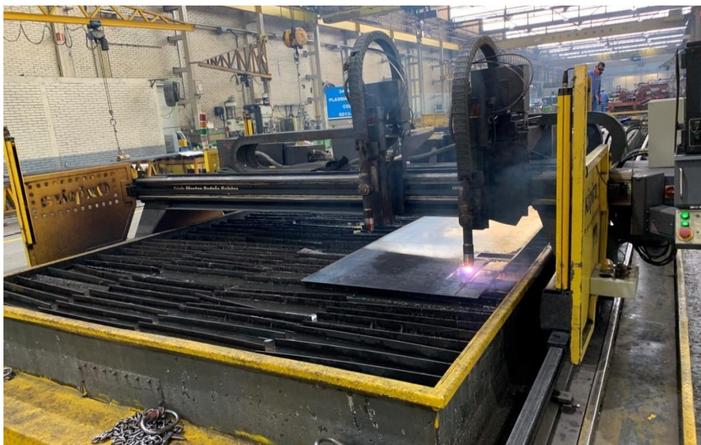
Figura 14 – Equipamento Oxipira de corte térmico a plasma
