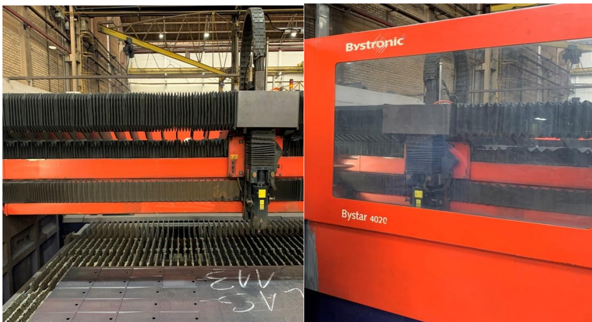
Figura 12 – Equipamento Bystronic de corte térmico a laser CO 2
