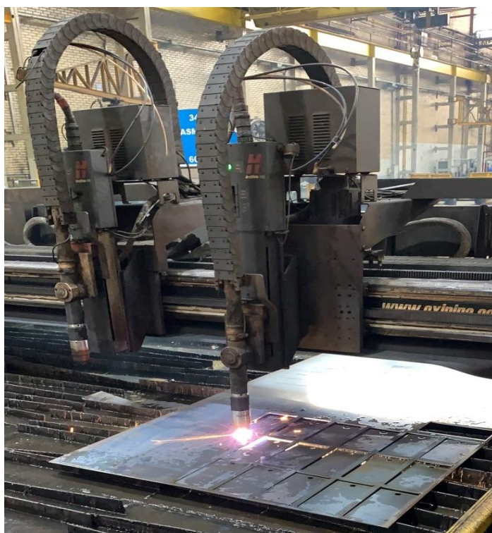
Figura 15 – Processamento a plasma dos CP's
