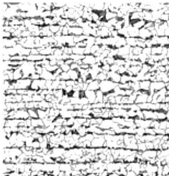
Figura 1 – Microestrutura de um aço hipoeutetóide constituído por ferrita e perlita
