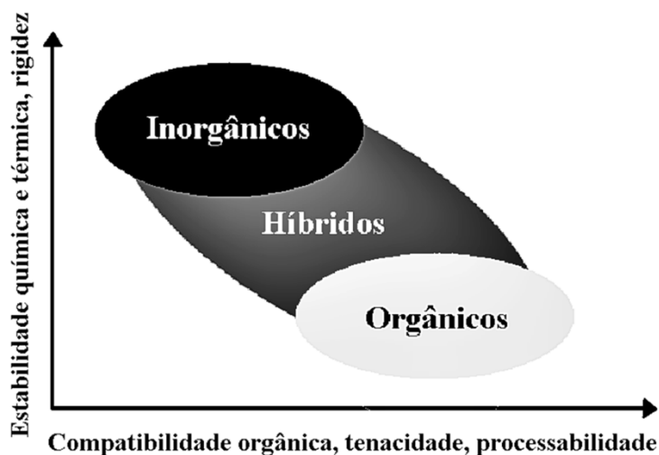
Figura 3 – Relação esquemática de propriedades entre materiais orgânicos, inorgânicos e híbridos. Adaptado de [18].
