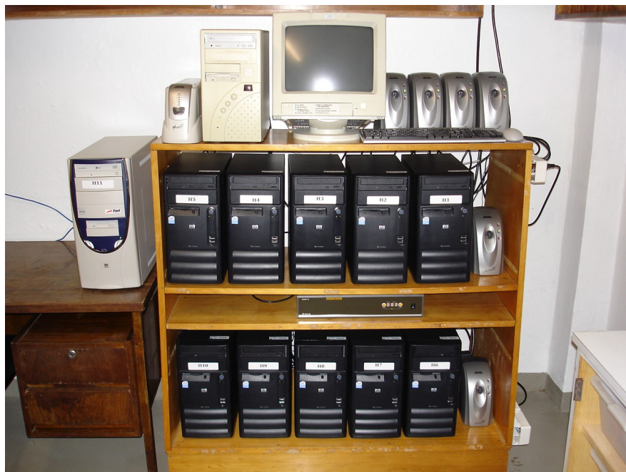
Figura 12: Hal – cluster de doze computadores instalado no Laboratório de Física da UCS.
