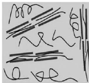
**Figura 8** – Representação esquemática da estrutura de nanocompósitos com morfologia flocular [19].
