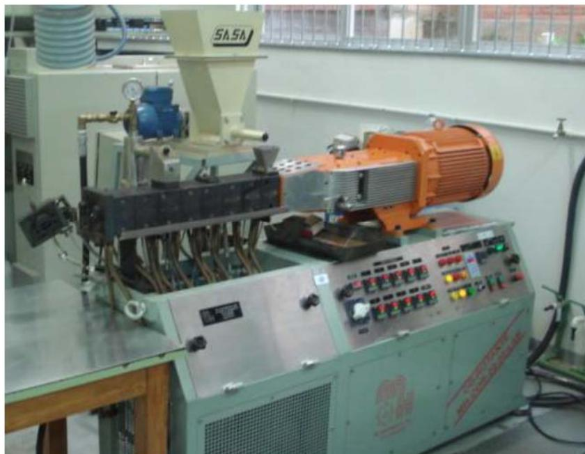
**Figura 19** – Extrusora dupla rosca utilizada para obter a tinta nanoestruturada.
