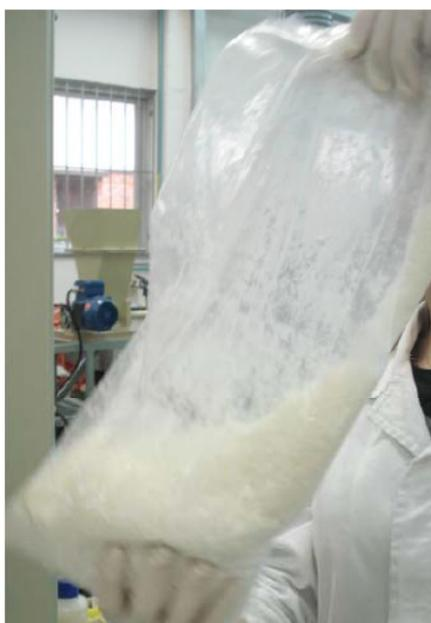
Figura 18 – Pré-mistura manual dos componentes da tinta.
