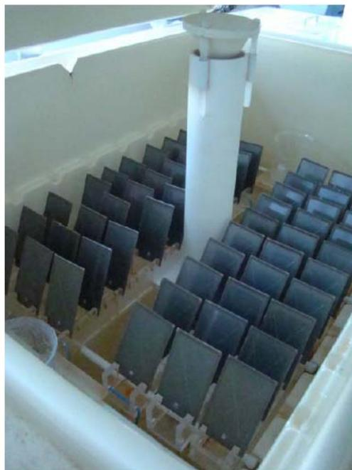
**Figura 28** – Sistema de fixação na câmara de névoa salina das chapas metálicas revestidas com as tintas em pó base epóxi contendo teores de 0, 2 e 4 % de MMT (p/p).
