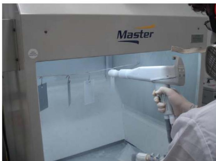
**Figura 23** – Processo de aplicação da tinta por pulverização eletrostática.
