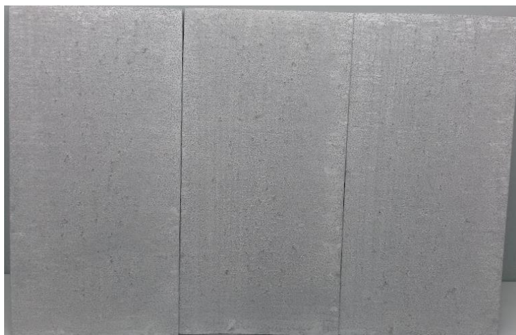
Figura 32 – Chapa com 120 h de ensaio em salt spray acético
