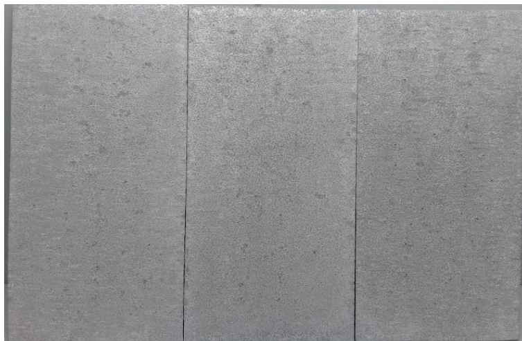
Figura 35 – Chapa com 336 h de ensaio em salt spray acético
