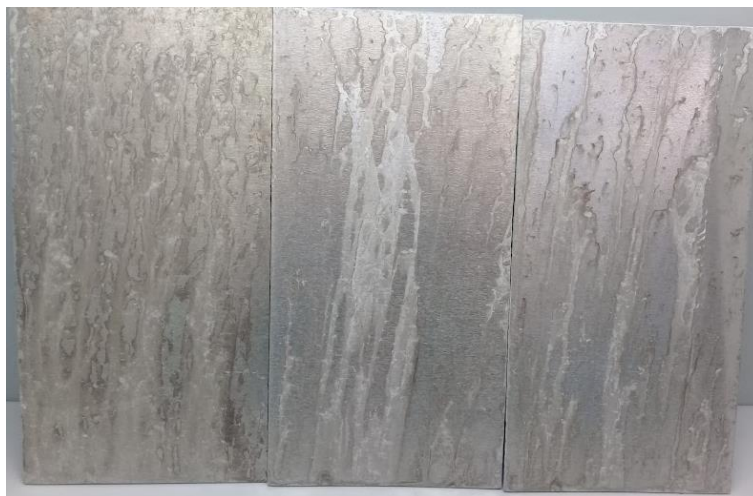
Figura 18 – Chapa com 120 h de ensaio em salt spray neutro
