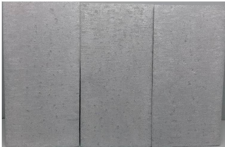
Figura 34 – Chapa com 168 h de ensaio em salt spray acético
