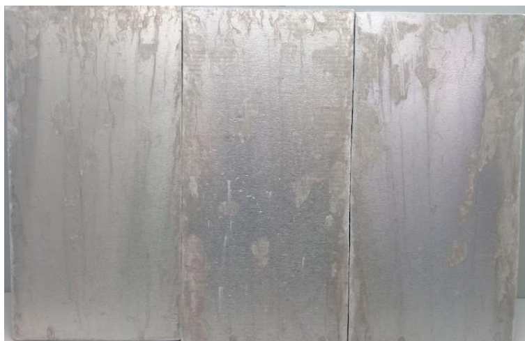
Figura 23 – Chapa com 672 h de ensaio em salt spray neutro
