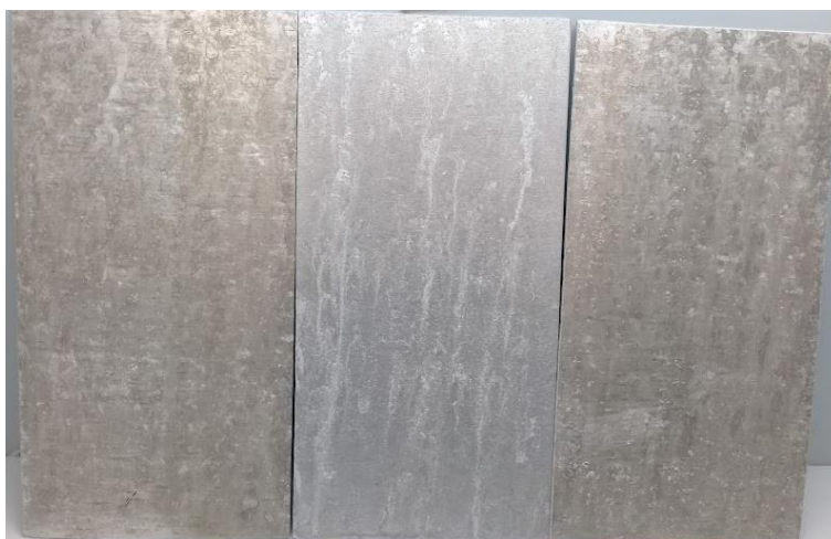
Figura 17 – Chapa com 96 h de ensaio em salt spray neutro
