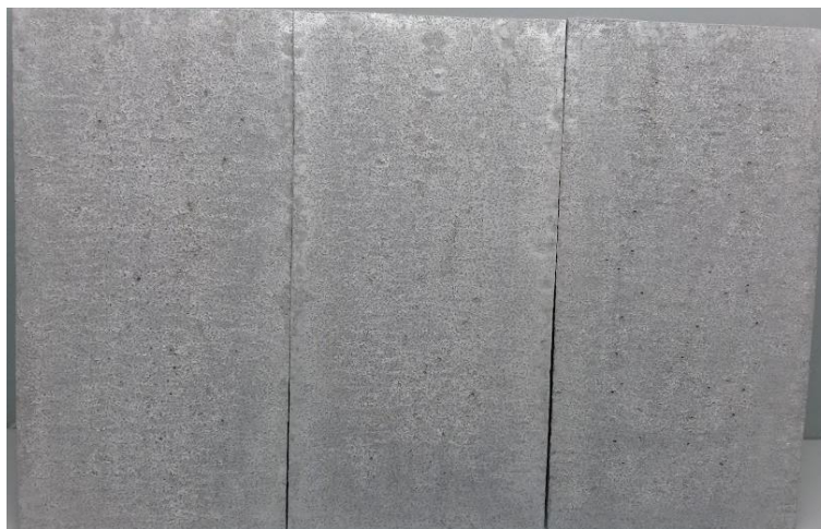
Figura 36 – Chapa com 504 h de ensaio em salt spray acético
