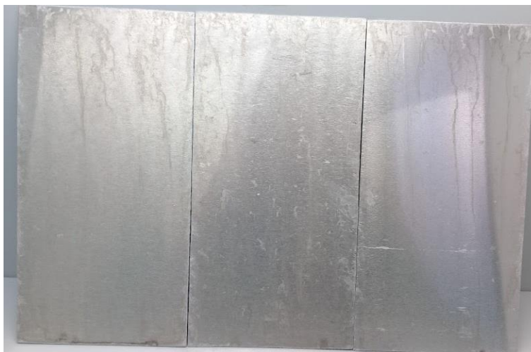
Figura 15 – Chapa com 48 h de ensaio em salt spray neutro
