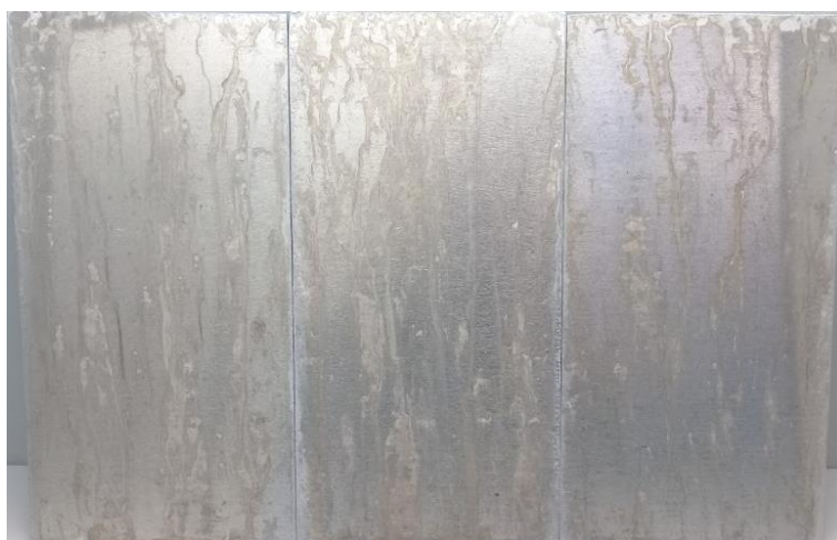
Figura 22 – Chapa com 504 h de ensaio em salt spray neutro
