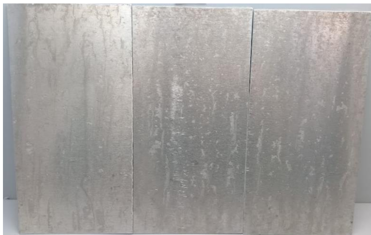
Figura 14 – Chapa com 24 h de ensaio em salt spray neutro
