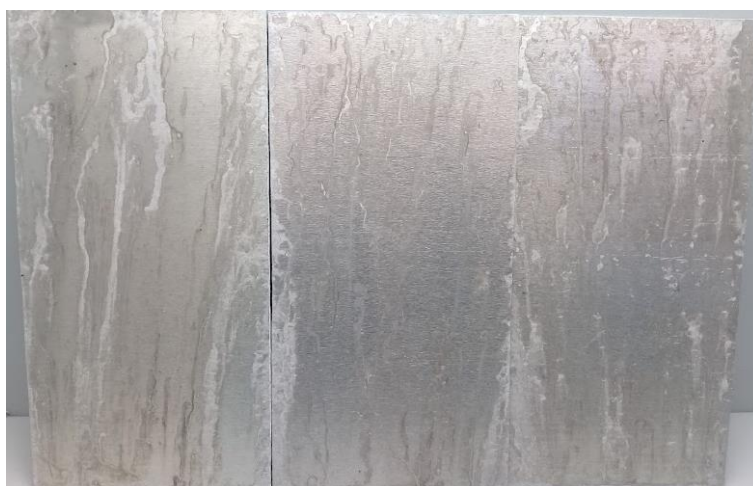
Figura 19 – Chapa com 144 h de ensaio em salt spray neutro
