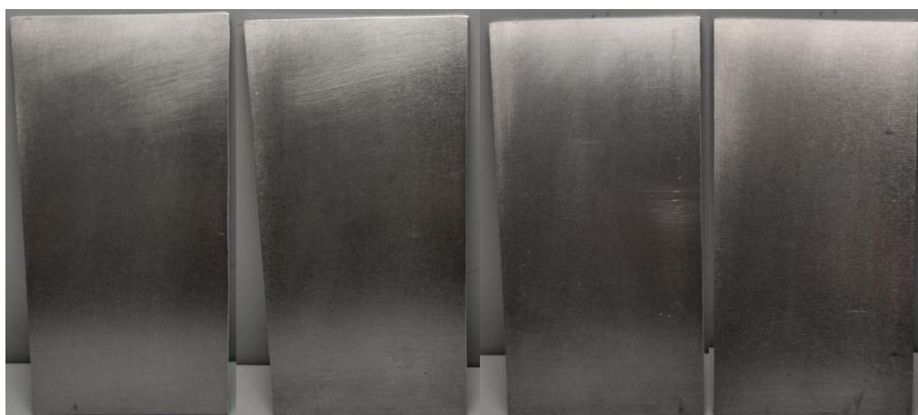
Figura 26 – Chapas com 1 h, 2 h, 3 h e 4 h de ensaio em salt spray acético
