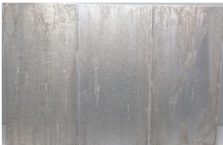
Figura 25 – Chapa com 1000 h de ensaio em salt spray neutro
