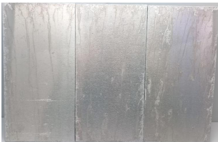
Figura 16 – Chapa com 72 h de ensaio em salt spray neutro
