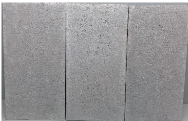
Figura 37 – Chapa com 672 h de ensaio em salt spray acético
