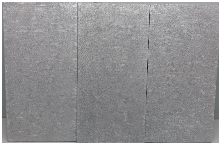
Figura 30 – Chapa com 72 h de ensaio em salt spray acético
