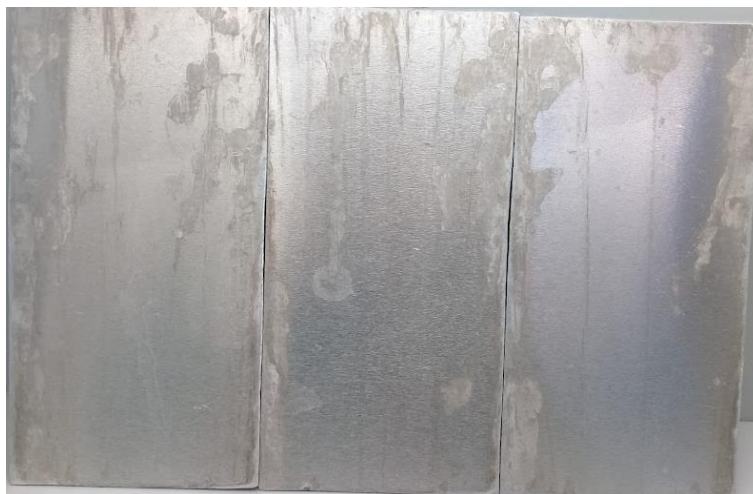
Figura 24 – Chapa com 840 h de ensaio em salt spray neutro
