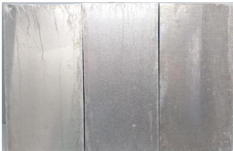
Figura 21 – Chapa com 336 h de ensaio em salt spray neutro
