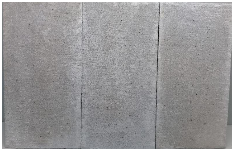
Figura 38 – Chapa com 840 h de ensaio em salt spray acético
