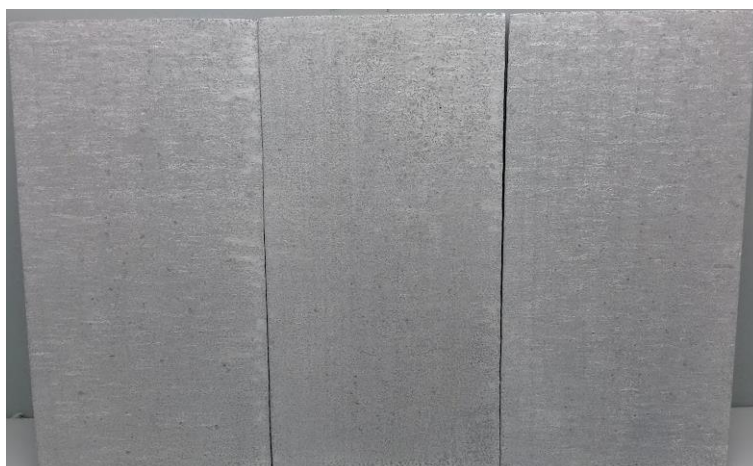
Figura 31 – Chapa com 96 h de ensaio em salt spray acético
