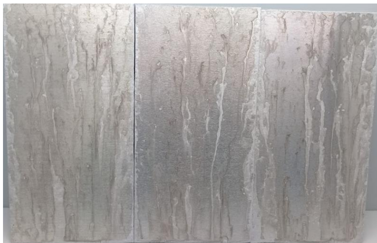
Figura 20 – Chapa com 168 h de ensaio em salt spray neutro
