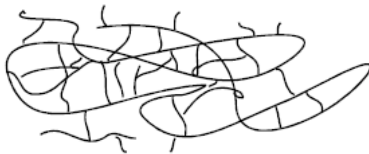
Figura 2 - Cadeia típica de um polímero termorrígido.
