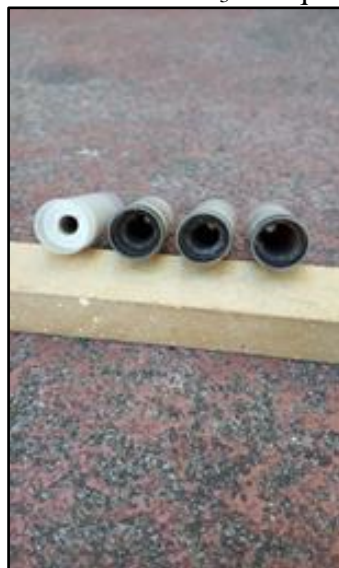
Figura 19 – Motores-foguete de PP com \text{NaNO}_3 não queimados adequadamente
