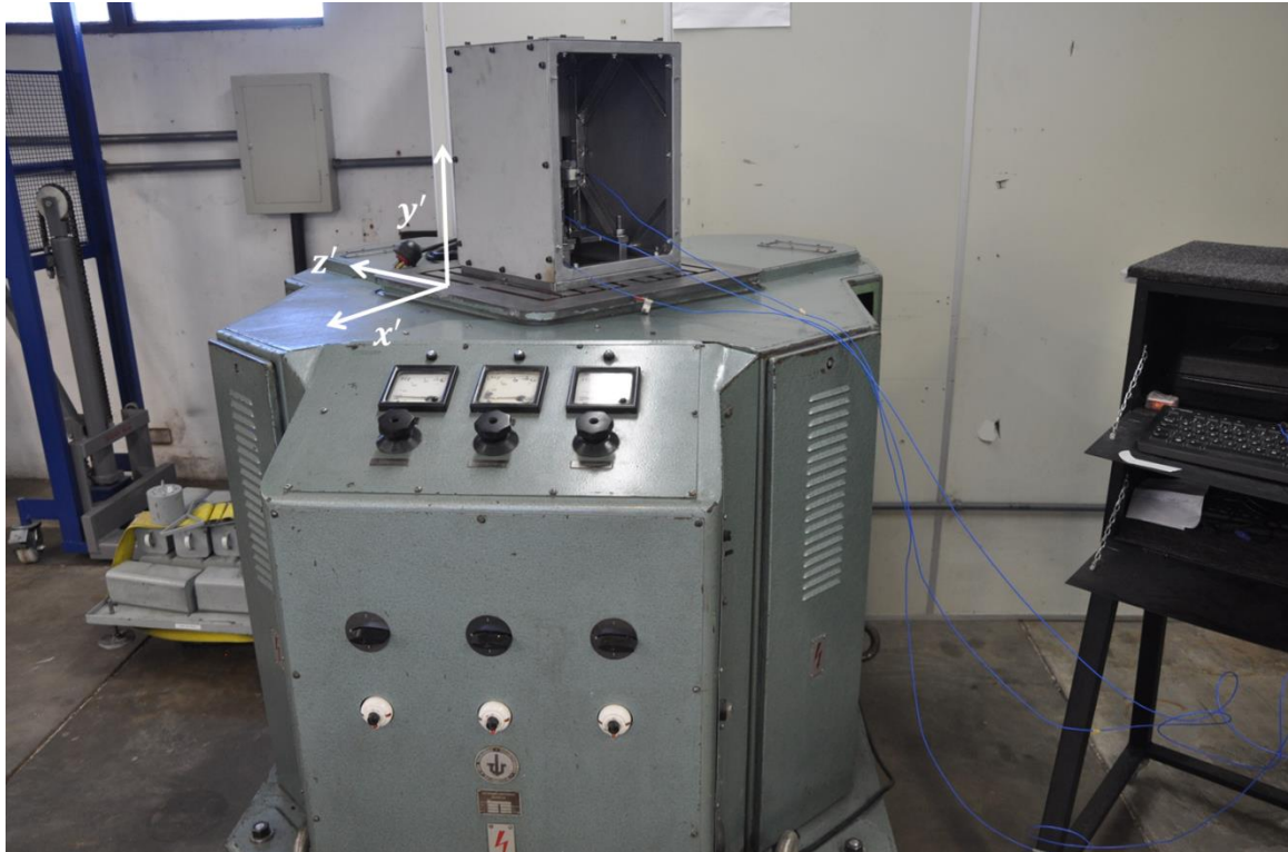
Figura 23 - Shaker eletromecânico e os eixos de vibração.
