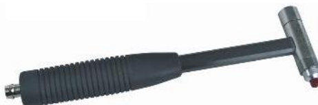
Figura 26 - Martelo de impacto da marca PCB ® , modelo 086C03.
