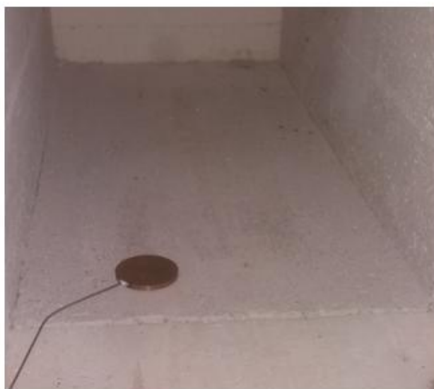
Figura 36 –Amostra instrumentada para maior precisão na medição de temperatura do tratamento térmico.
