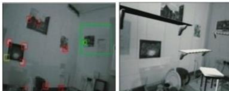
Figura 10 - Inicialização para rastreamento utilizando SLAM através de objeto conhecido (objeto verde à esquerda) e cena aumentada com quatro objetos virtuais ao longo do rastreamento (direita)
