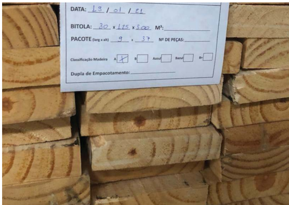
Figura 21 – PAPEL COLADO NO BLOCO COM AS MEDIDAS, AINDA SEM O CÁLCULO DO VOLUME
