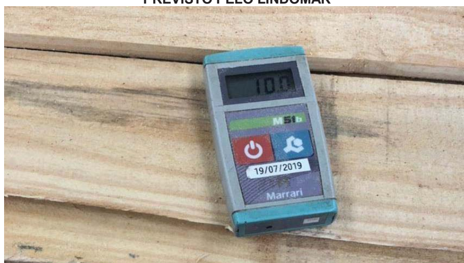
Figura 22: APARELHO MANUAL PARA MEDIR A UMIDADE DA MADEIRA COM O NÚMERO PREVISTO PELO LINDOMAR
