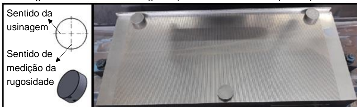
Figura 20 - Sentido da usinagem e posicionamento dos corpos de prova.
