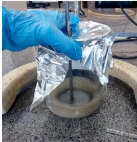
**Figura 14** - Agitação mecânica da resina poliéster/CNF.
