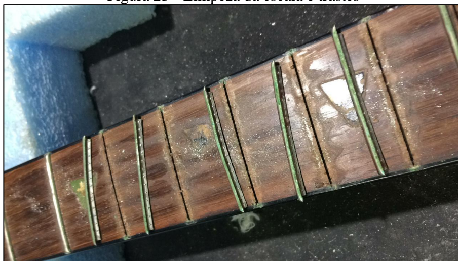
Figura 23 - Limpeza da escala e trastes
