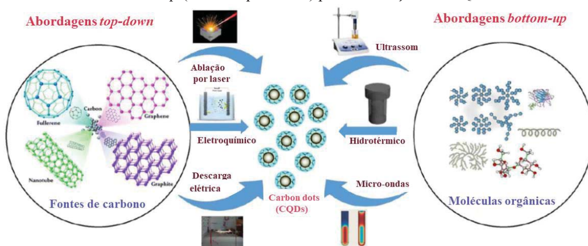
Figura 5 – Diagrama esquemático dos métodos de síntese top-down (de cima para baixo) e bottom-up (de baixo para cima) para a obtenção dos CQDs
