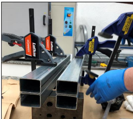
Figura 27 - Pressão aplicada em corpos de prova para maior aderência
