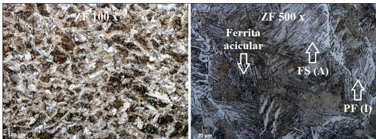
Figura 36 - Micrografias na zona fundida do aço SAE 1010
