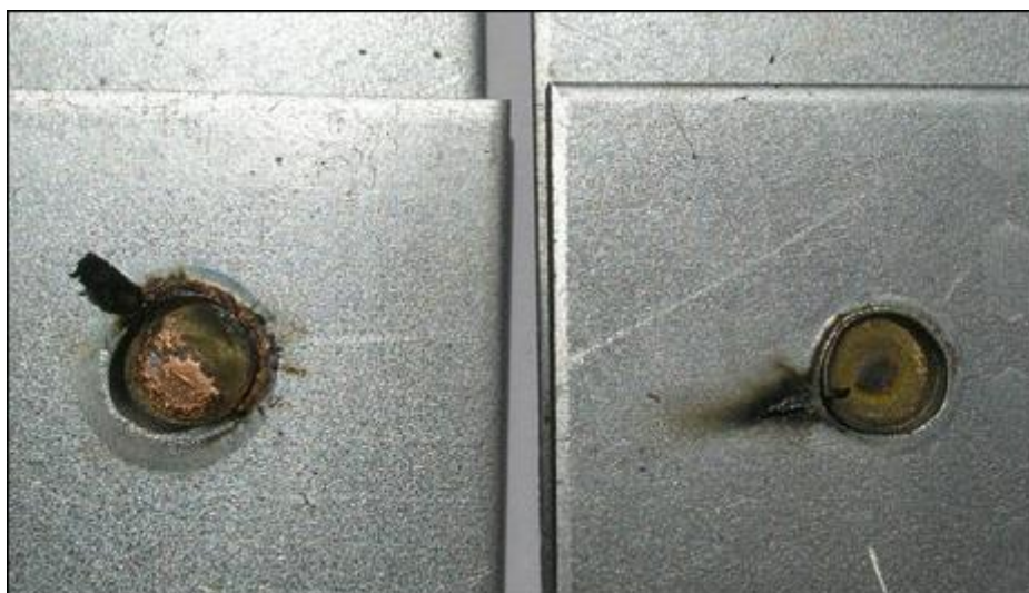
Figura 7 - Expulsão de metal fundido na soldagem por pontos
