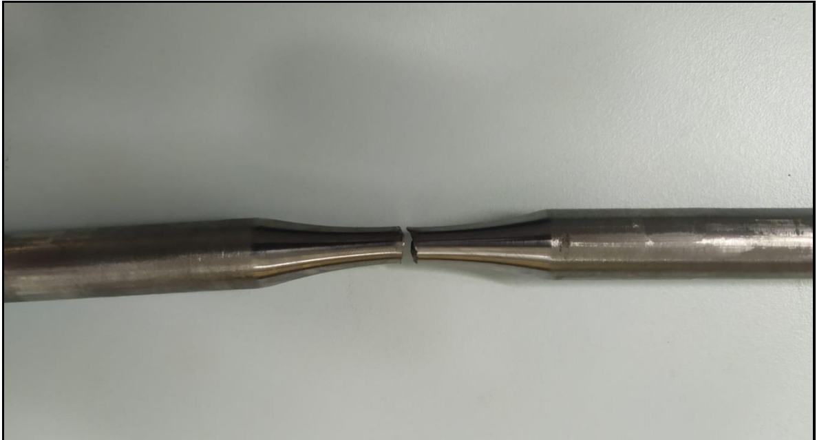
Figura 30 – Corpo de prova rompido
