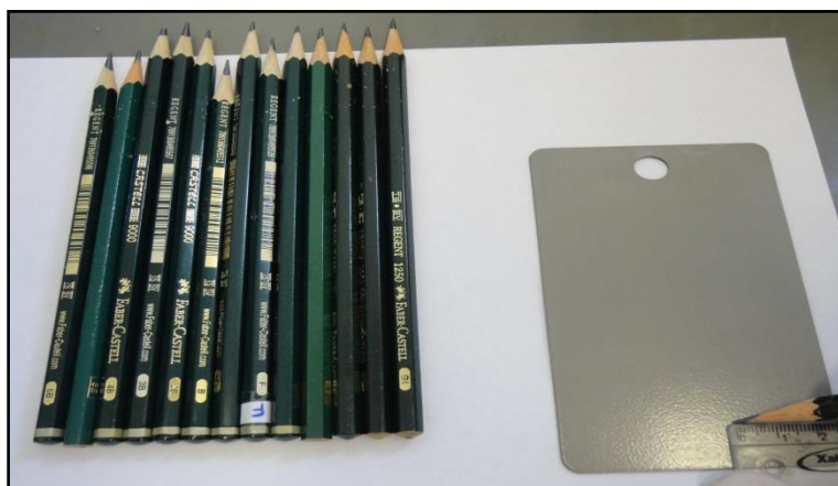
Figura 13. Teste de dureza utilizando lápis de diferentes grafites.
