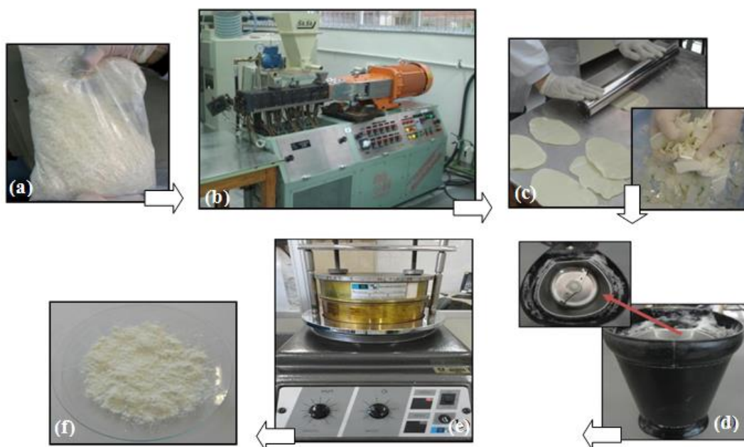
Figura 9. Fluxograma da obtenção da TA com MMT-15A, MMT-30B e Mica moscovita. A sequência da preparação da tinta em pó acrílica dá-se da seguinte maneira: (a) mistura dos componentes de forma manual, (b) mistura mecânica com extrusora duplarrosca, (c) obtenção de chips , (d) moagem por moinho de facas, (e) peneiramento por agitação e (f) pó obtido.
