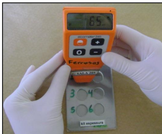
Figura 11. Gabarito e medidor de espessura utilizado para as medidas de espessura dos filmes.
