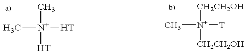
Figura 8. Estrutura química do modificador orgânico da argila (a) Cloisite® 15A e (b) Cloisite® 30B. Fonte: SOUTHERN CLAY PRODUCTS, INC. Product Bulletin/Cloisite®.
