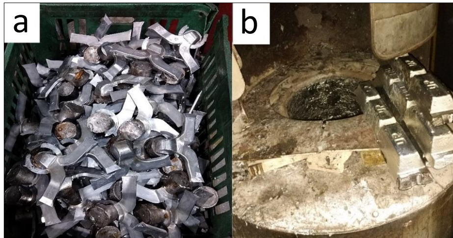
a) Materiais de refugo (retorno) adicionados ao banho; b) Lingotes de alumínio SAE 305 sendo pré-aquecidos na parte superior do forno.
