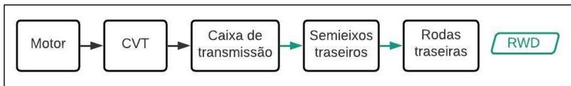
Figura 16 – Configuração atual de powertrain do veículo da equipe TOBAJA.
