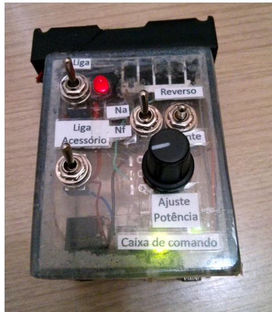
Fotografia 01 : Painel da Caixa de Comando
