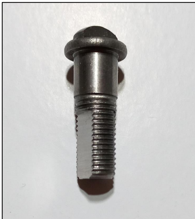
Figura 31 - Haste rosqueada conformada finalizada após brochamento
