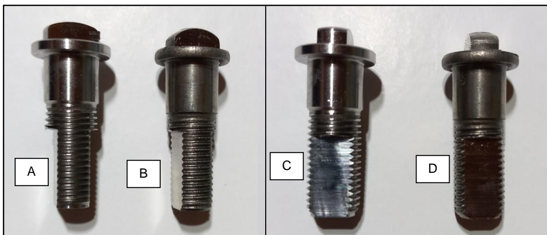
Figura 32 - Hastes usinadas A e C, hastes conformadas B e D
