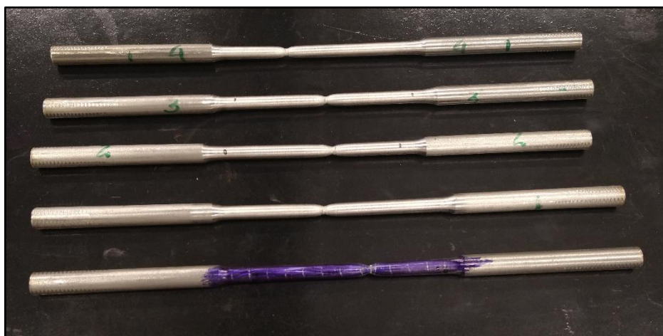
Figura 18 - Corpos de prova após o ensaio de tração
