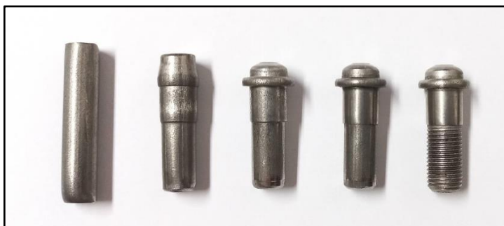
Figura 30 - Estágios de conformação - fabricação do produto
