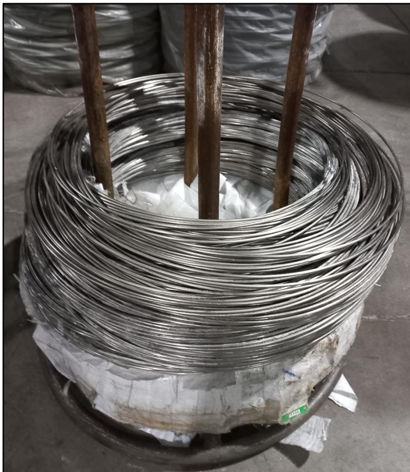
Figura 16 - Rolo de arame acondicionado em estocador
