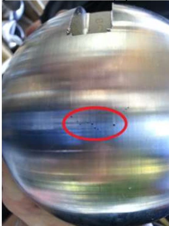
Figura 22 – Porosidade nas peças usinadas
