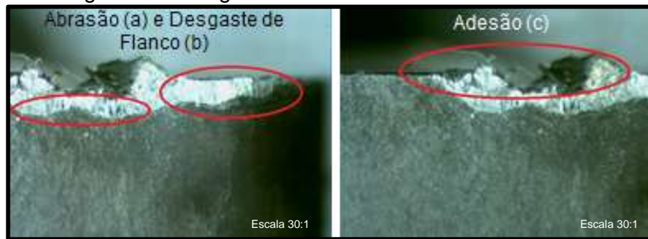
Figura 27 - Desgastes da amostra V classe AC6040M
