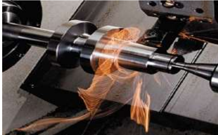
Figura 2 – Torneamento retilíneo cilíndrico externo
