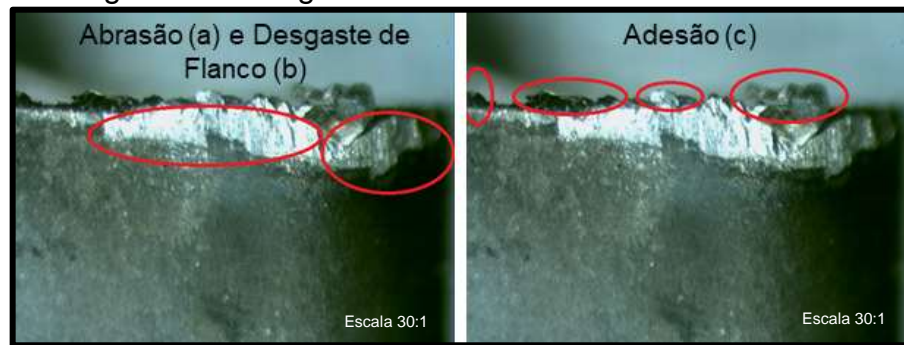
Figura 26 - Desgastes da amostra IV classe AC6030M
