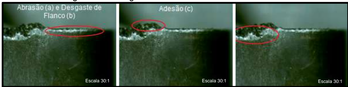
Figura 28 - Desgastes da amostra VI classe AC6040M
