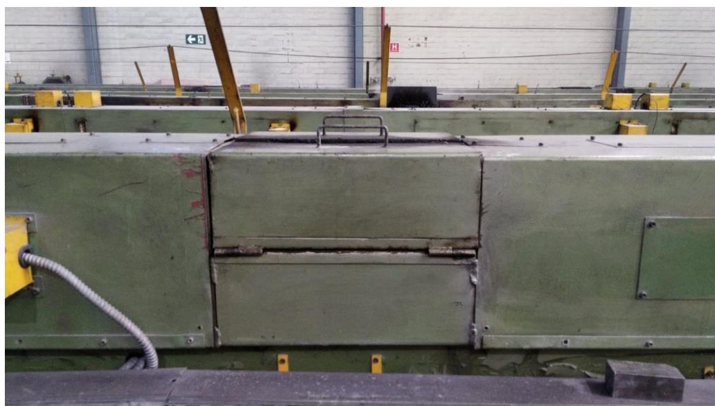
Figura 20 - Porta soldada entre dois módulos
