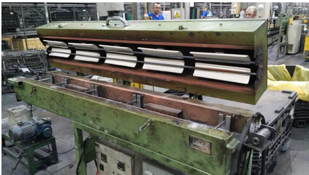
Figura 29 - Túnel de pré-choque
